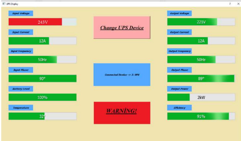
Şekil 4.29. Şebekeden gelen yüksek gerilim durumunda alarm ekranı
