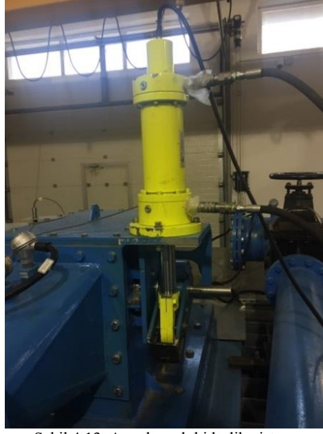
Şekil 4.13. Ayar kanadı hidrolik pistonu
