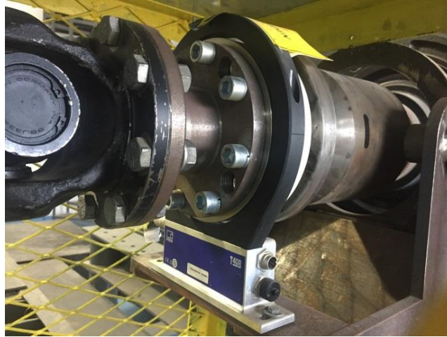
Şekil 4.7. Torkmetre türbin mili bağlantısı
